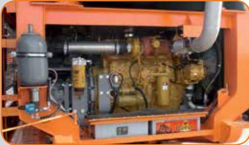
Das Antriebssystem befindet sich im Heck der Maschine und ist schalldämmend eingehaust. Für Wartungs- und Reparaturzwecke kann die Einhausung allseitig großflächig geöffnet werden. Über ein direkt am Motor angeflanshtes Verteilergetriebe wird die Hydraulikpumpe für alle Nebenantriebe (Hauptband, Seitenband, Vibrorinne, Fahrwerk...) sowie die Pum-
