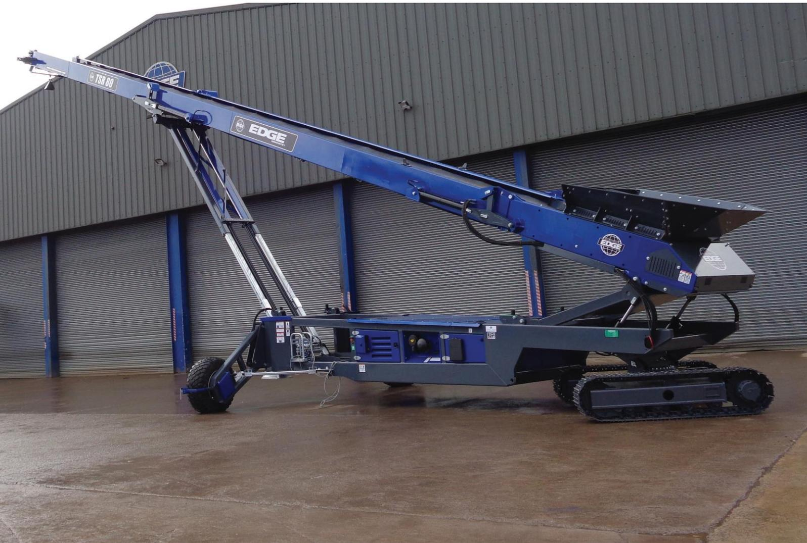
Das EDGE TSR80 ist ein 24 m langes Kettenmobiles Band zur kreisförmigen Aufhaltung. Die Vorteile kettenmobil und radiales Aufhalten vereint in einem leistungsstarken Produkt. Das TSR80 kombinierte die selbständige Fortbewegung in schwierigstem Gelände mit größtmöglicher nierenförmiger Materialaufhaltung. Die perfekte Lösung für mobile und großvolumige Aufhaltung jeglicher Art von Schüttgütern.
