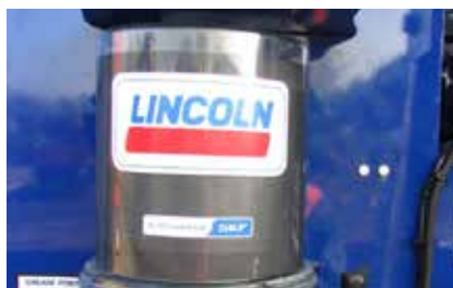
Zentralschmieranlage - schützt vor übermäßigem Verschleiß der Komponenten
