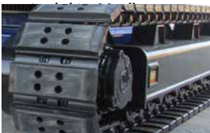
Gummiketten - sind für den Einsatz auf harten Untergründen prädestiniert
